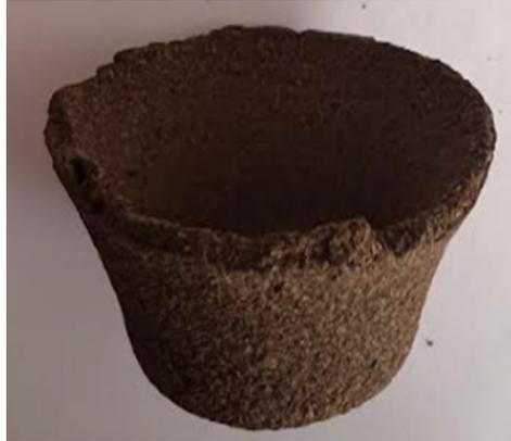
La última prueba se realizó con una granulometría más fina (Figura 9), quedó de un color café más claro y con mejor apariencia que los otros resultados, quedando aún rígida pero más flexible que las anteriores, esto dio paso a un material de superficie homogénea que mantiene los colores de la muestra inicial sin perder su volumen.
