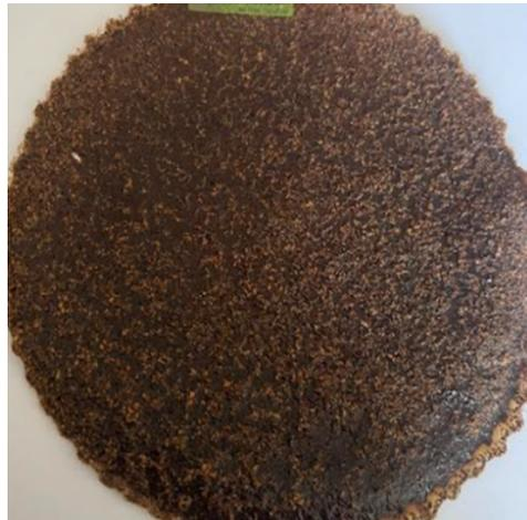
La última lamina realizada con gelatina (Figura 6), en un molde circular con un mismo gramaje que las otras dos láminas anteriores, se puede observar que la lámina es más porosa de color café oscuro, se logró mayor resistencia sin perder su textura y flexibilidad, quedando
