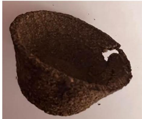
La segunda prueba se realizó con una granulometría mixta, 50% granos triturados más gruesos y el otro 50% más fino de la cáscara de nuez (Figura 8), se pudo observar que el material quedó de color café oscuro y con una textura rígida no flexible y se puede romper con facilidad.
