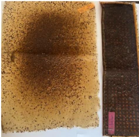
En la primera prueba de lámina de gelatina (Figura 4) se utilizó un molde cuadrado, para la elaboración se utilizó un gramaje menos triturado de cáscara de nuez, se puede observar que su color es más claro en los bordes y más oscura en el centro, el material se concentró al centro de la lámina donde quedó más gruesa, en cambio quedó más delgada en sus bordes; al estirar la lámina se puede romper por su fragilidad.
